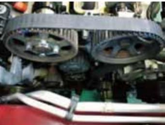
では交換時期はいつなんでしょう？これは熟練したメカニックの経験から導き出されます。弊社では年数は5年～7年。距離は4万キロ～5万キロの間での交換をお勧めしています。もちろんこれ以上にも固体も存在します。しかし前記した通りタイミングベルトの交換は予防整備です。で、何が起きる前に行う事をお勧め致しております。実際の交換作業はベルトを外して元の位置に組めばオッケー！といったってシンプルです。と言つてもエンジンがブローしていなくとも適正の位置から必ず微妙なずれがあるじます。その微妙なずれがあるとエンジンは本来の性能を発揮しません。
