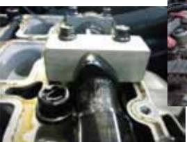
このタイミングがズレてしまうとピストンとバルブが衝突し、エンジンブローとなります。と、簡単に書いてしまいましたが、たかがベルトではありますか車の心臓部品ですがタイミングベルト及びエンジンを動かす上で非常に大切な部品です。そんな大切な部品ですがタイミングベルト及びベルト残念ながら消耗品です。車種にもりますが、素材はベルトはゴム、ベアリングはプラスチック
